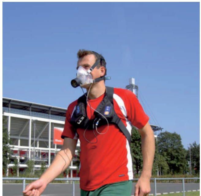
Abb. 3 Fortschritte in der Messtechnik und der Datenübertragung (Telemetrie) ermöglichen immer kleinere und handlichere Geräte. Tragbare Messeinrichtungen werden in der Sportmedizin verwendet. Hier ist der Einsatz bei der DHS (Deutsche Sporthochschule) in Köln abgebildet. Abbildung J. Latsch, Köln.
